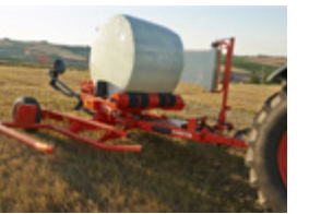
LANDBOUWGEREEDSCHAP Draaitafel wikkelaars
